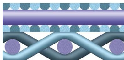
POREFLO ist ein zwei- bis dreilagiges Laminat aus versetzt geschichteten Tressengeweben. Durch die nachträgliche Oberflächenverdichtung verändert sich das Laminat in eine luftdurchlässige metallische Membrane mit einer hohen Stabilität und geringen Porosität. POREFLO ist besonders geeignet für Anwendungen, bei denen hohe Durchflusswiderstände erwünscht sind.
