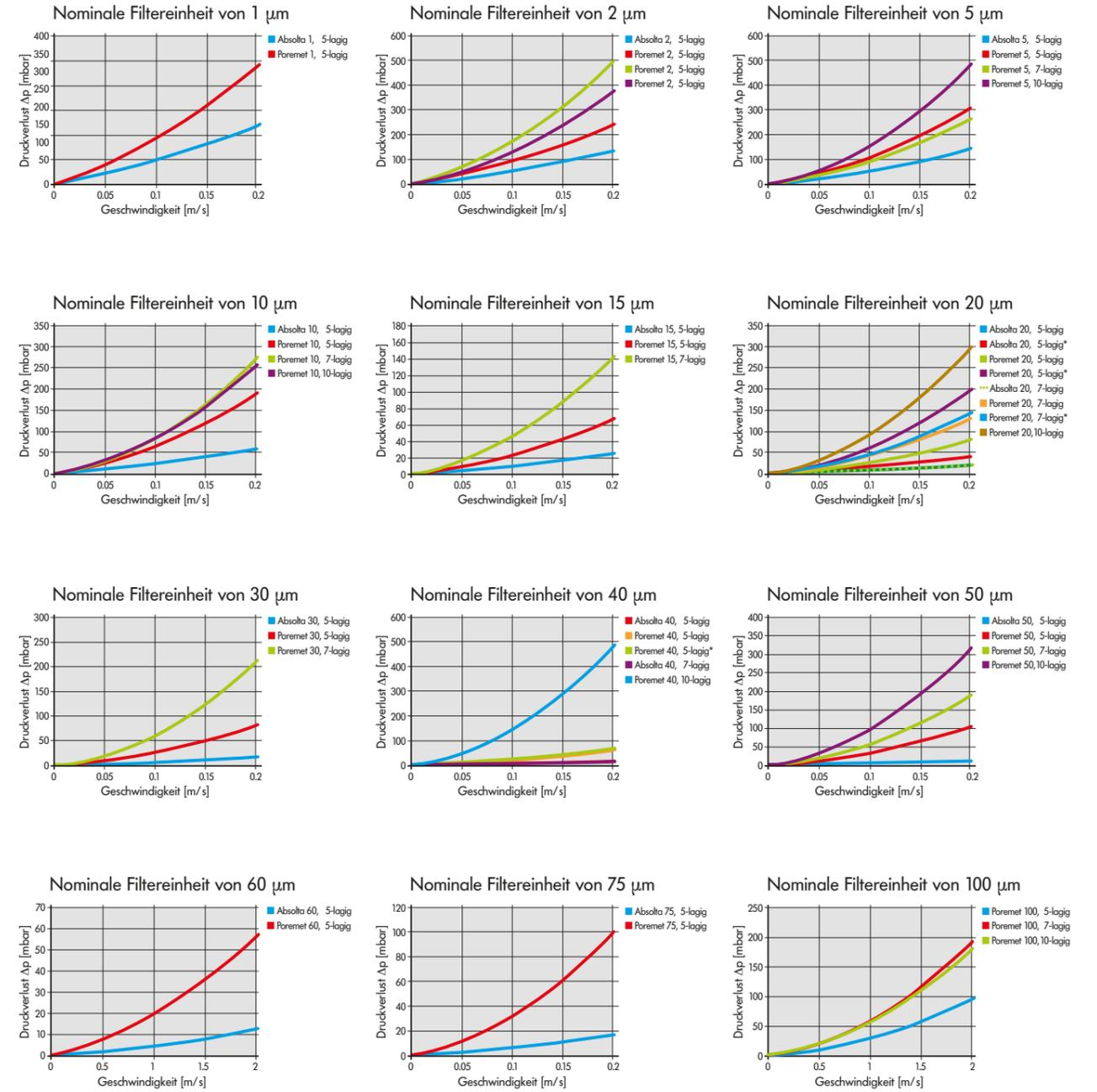
\*Aufgrund spezieller Legierungen unterschiedliches Filtergewebe
