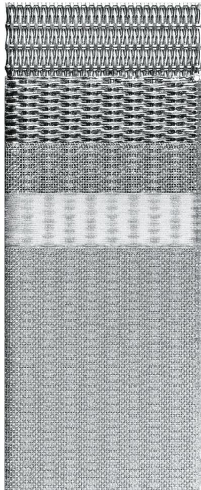
Das blechartige Filtermedium besteht aus fünf verschiedenen Gewebelagen, die so aufeinander abgestimmt sind, dass eine optimale Kombination zwischen Festigkeit, Filtrationsfeinheit, Durchflussleistung und Rück-
