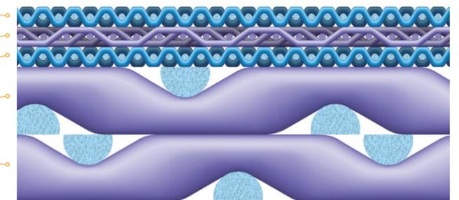
ABSOLTA wie POREMET lassen sich mit einer Vielzahl von Stützgeweben oder Gittern kombinieren, wodurch eine enorme Belastbarkeit erzielt werden kann.
