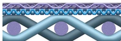
Das Laminat verfügt gegenüber dem TOPMESH 2 über eine zusätzliche Verbindungslage zwischen dem Filtergewebe und der Stützlage aus Quadratmaschengewebe. Bei praktisch gleichbleibend geringen Durchflusswiderständen und guter Rückspülfähigkeit können höhere Druckbelastungen bewältigt werden. Auch TOPMESH 3 eignet sich sehr gut für den Einsatz bei CIP-Filtern.
